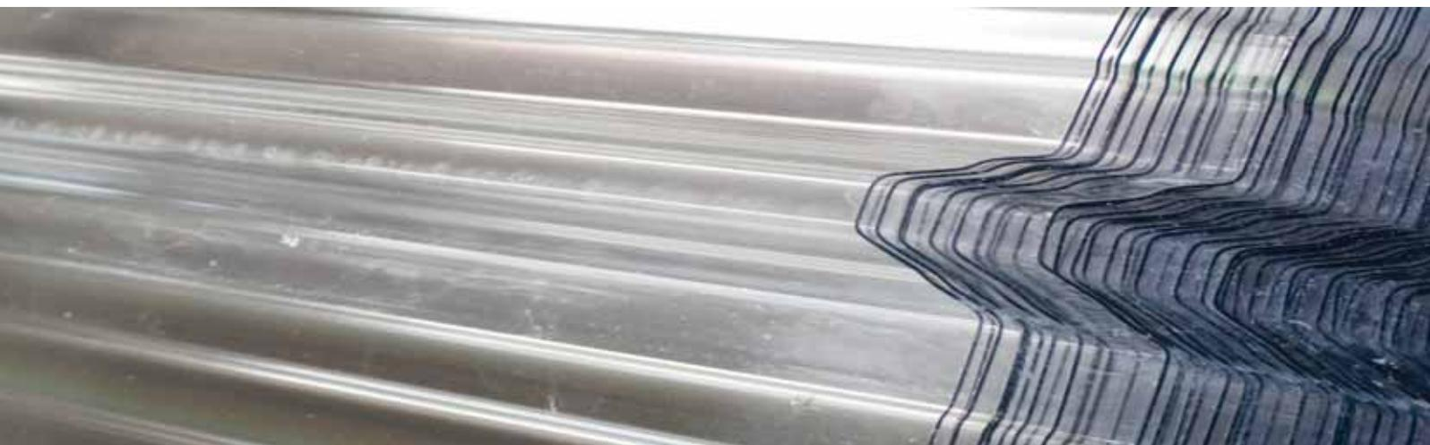
Fra tutti i materiali per la vetratura il polycarbonato è l'unico ad avere la massima resistenza ad un intervallo di temperatura che va dai  $-40^{\circ}$  ai  $+130^{\circ}\text{C}$ , ed è duecento volte più resistente del vetro. Una tale resistenza permette anche di applicare la lastra in quelle aree dove vi è maggiore pericolo di danni, come in zone soggette a vandalismo o in grandinate, dove altri materiali per la vetratura si rivelerebbero inadeguati.
