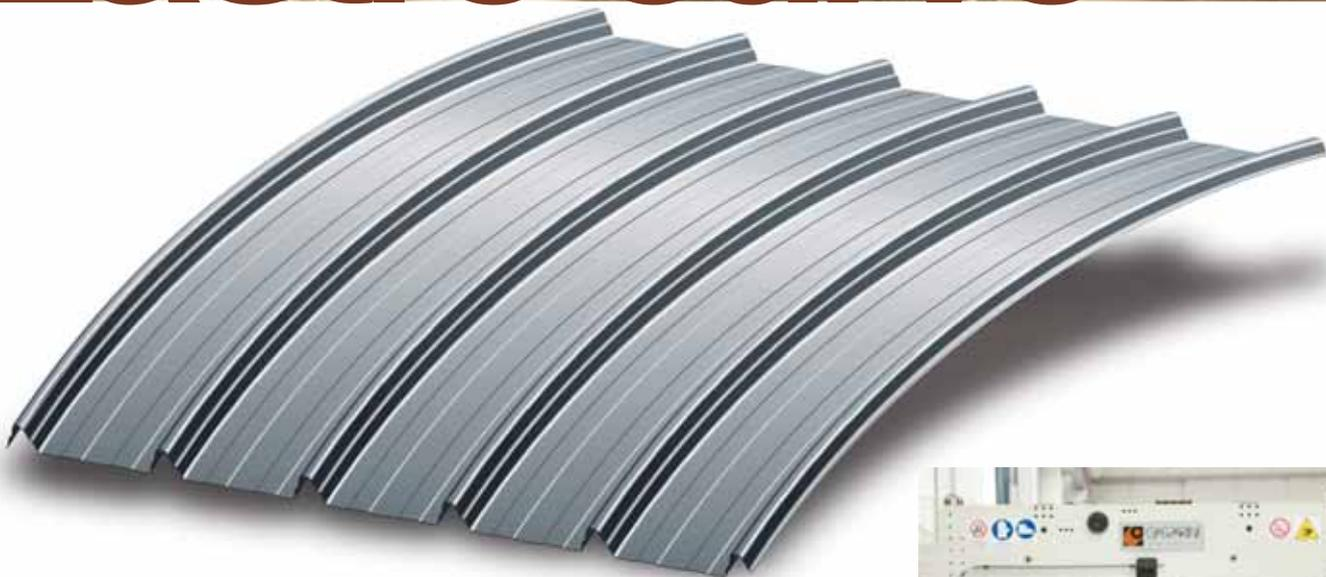
I nostri profili grecati SAND 20 SAND 28 SAND 35 SAND 38 SAND 40 SAND 55 possono essere curvati con tacchettatura per coperture di fabbricati a profilo semitondo. I profili 28 e 35 possono essere curvati con calandratura a microimpronta
